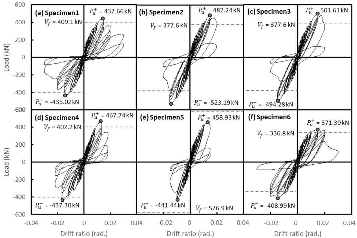
Fig. 3 Load-Drift ratio
